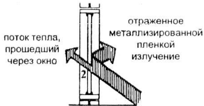
Рисунок 2.18 – Установка металлизированной пленки:
